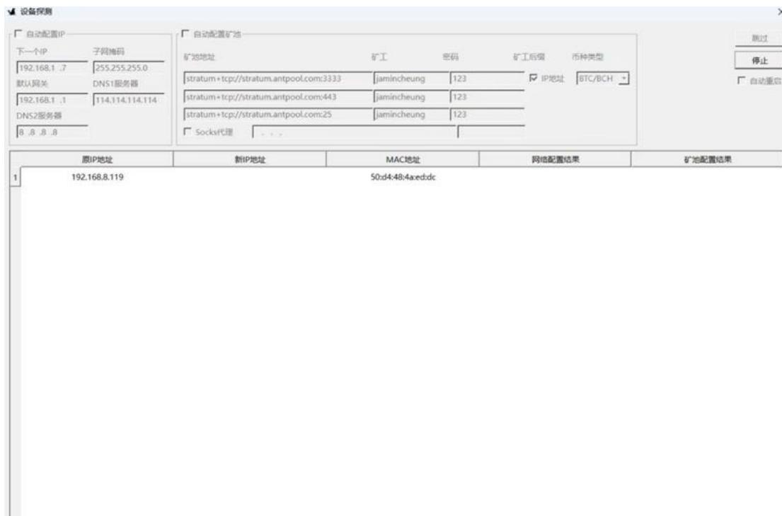
上报 IP 方法：启动矿机后，长按 5 秒矿机上的 IP Report 按钮，等待几秒软件上会显示出当前设备的IP(注意：管理工具的PC与矿机需在同一局域网内)。
