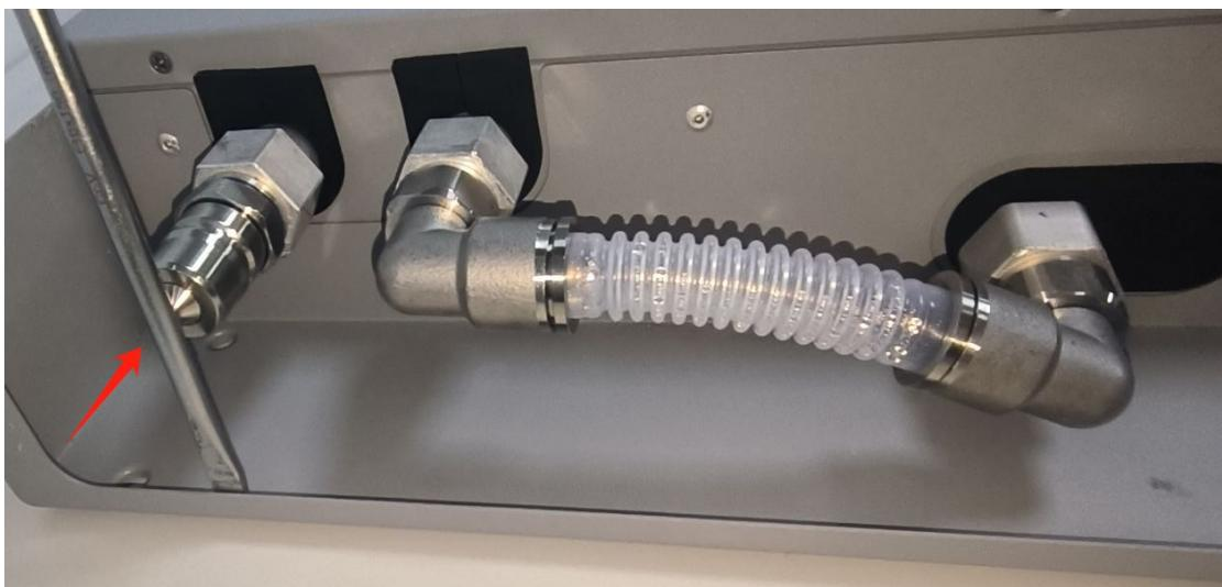
**(4)电源线拔开时请按住接头上下两侧的弹片。**
