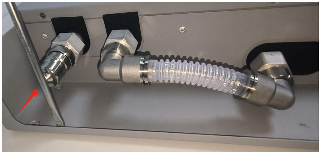
(4) 将算力板侧波纹软管拆除, 注意先将一边将快插接头的活动环向内按压, 再将波纹软管向外拔出。
