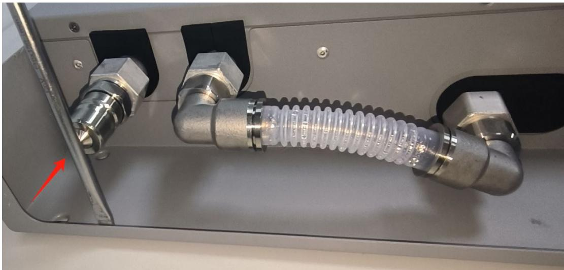
(3) 将电源侧波纹软管拆除，注意先将一边将快插接头的活动环向内按压，再将波纹软管向外拔出。
